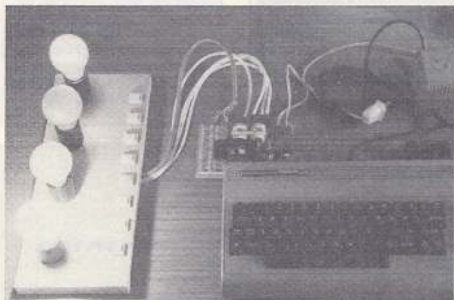
2 Vier Lampen werden mit dem C64 optimal gesteuert
