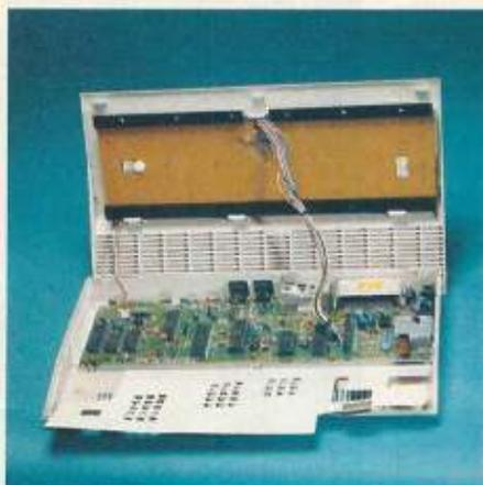
LED- und Tastaturstecker werden abgezogen und das komplette Oberteil zur Seite gelegt. Jetzt wird die Abschirmpappe entfernt und alle Schrauben aus der Platine gedreht. Die Platine läßt sich nun aus der unteren Gehäuselochschale heben. Das Betriebssystem (Pfeil) ist eingelötet und muß deshalb ausgebaut werden (für Schäden wird keine Haftung übernommen).
