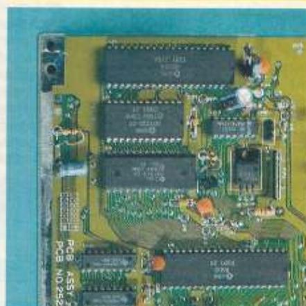
Hierbei machen aber drei Pins Schwierigkeiten. Diese sind auf der Platine mit großen Masseflächen verlötet, die die Wärme so schnell abführen, daß das Lötzinn nicht richtig flüssig wird.
