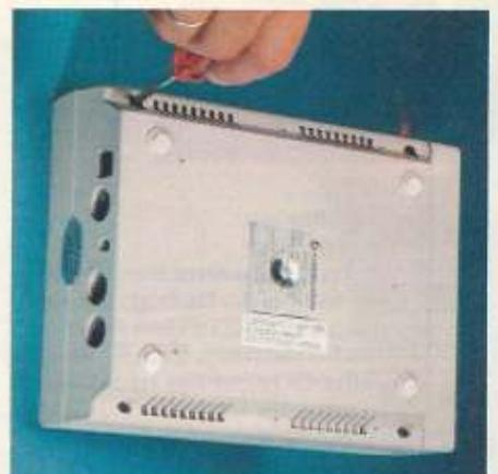
Das Diskettenlaufwerk wird umgedreht und alle vier Schrauben an der Unterseite werden entfernt. Jetzt kann das Laufwerk aus der oberen Halbschale gehoben werden.
