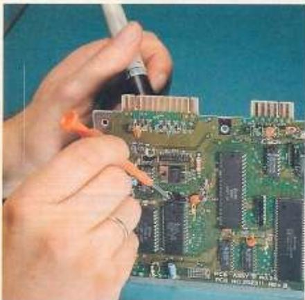
Deshalb hebeln wir den Chip während des Erhitzens mit einem Schraubendreher an einer Seite hoch. Dies wiederholen wir an der gegenüberliegenden Seite, bis der IC unbeschädigt herauskommt.
