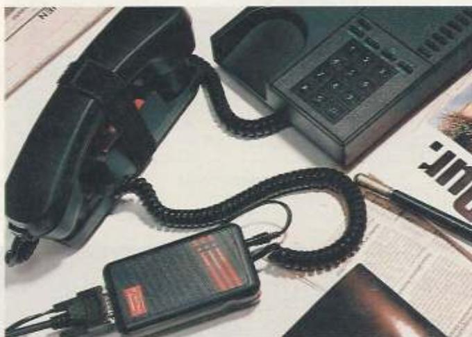
Mit Koppler und Modem alles komplett für mobiles Faxen
