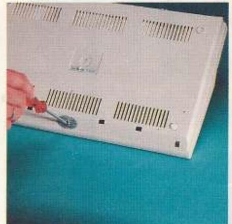
Zuerst wird der C64 geöffnet. Dazu sind entweder die Klammern an seiner Unterseite mit einem Schraubendreher nach außen zu drücken oder drei Schrauben zu lösen. Dabei geht das Garantiesiegel kaputt. (Achtung Garantieverlust!) Das Oberteil mit der Tastatur kann nun abgehoben werden.
