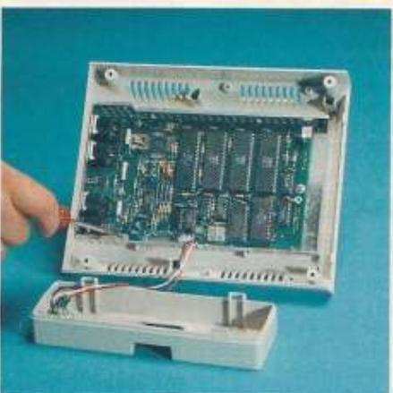
Die Platine liegt nun vor Ihnen. Bei manchen Laufwerken ist das Betriebssystem nicht gesockelt. Hier verfahren Sie wie beim Umbau der Computerplatine: Lösen Sie alle Schrauben, heben die Elektronik heraus und löten das IC aus.
