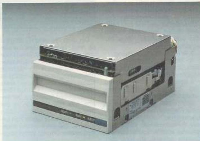
Ein modernes Laufwerk mit wechselbarer Festplatte
