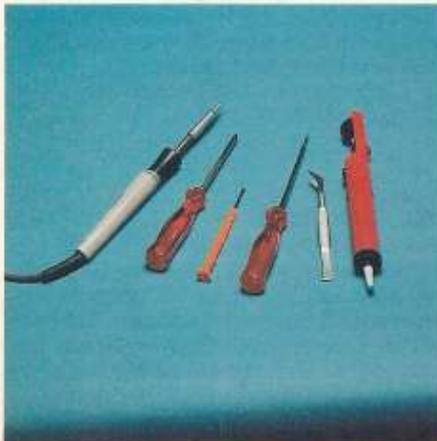
Folgendes Werkzeug ist zum Einbau des Speeders nötig: drei Schraubendreher (Kreuzschlitz, ein großer und ein kleiner mit Flachklinge), Pinzette, LötKolben und Entlötpumpe.
