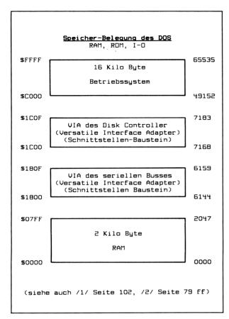
Nun lassen sich Maschinen-Programme nicht nur aus dem ROM der 1541 starten, sondern auch von der Diskette ins RAM laden und von dort starten. Selbstverständlich geht dies über "B-R" und anschließendem "M-E". der BLOCK-EXECUTE-Befehl "B-E" erledigt dies jedoch mit einem Aufruf. Das Maschinen-Programm wird mit dem ersten Byte ausgeführt und muß ebenfalls mit RTS enden.
